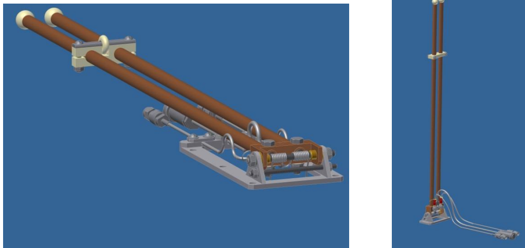
Рис. П.2 Внешний вид резонансной измерительной системы (трехмерное моделирование в системе AUTOCAD): слева – в транспортном (сложенном) состоянии, справа – в рабочем положении.
