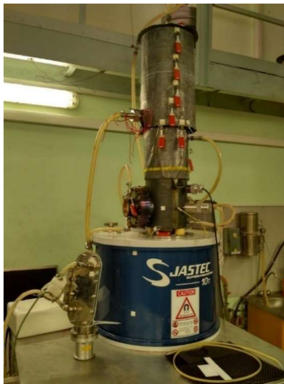
Рисунок 1.24 — Общий вид гиротрона с рабочей частотой 250 ГГц, установленного в криомагните [90]
