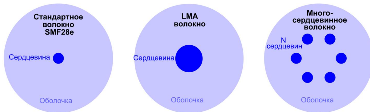
Рисунок 1.7. Схема поперечных сечений кварцевых волокон различного типа.
