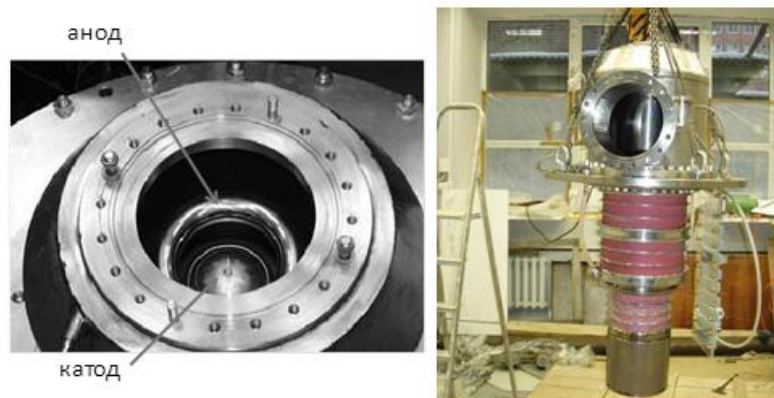
Рисунок 1.3. Внешний вид катодно-анодного узла магнетронно-инжекционной пушки
