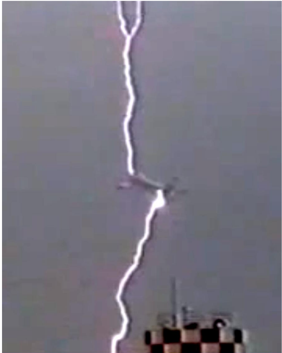
Рисунок 5.1. Молнии, инициированные самолётом на взлёте (скорость 65-100 м/с). С носа самолета движется восходящий положительный лидер, черной стрелкой отмечено возможное место контакта восходящего лидера и хвоста самолета (Любезно предоставлено Z.I. Kawasaki).
