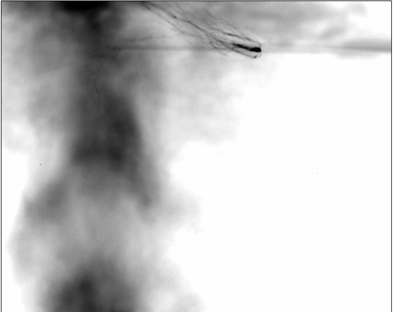
Рисунок 5.26 (Событие 121-304+_2013-01-30, заряд облака – Плюс). ИК-изображение, которое фиксирует образование сети плазменных образований, поднимающихся вверх с середины болта. Болт движется справа-налево. Выдержка кадров 7 мс, частота кадров 115 Гц, 640x512 пикселей.
