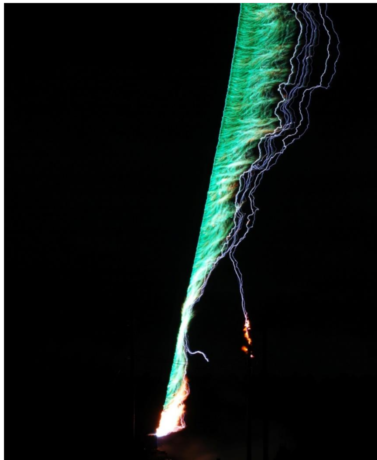
Рисунок 5.6 [Rakov and Uman, 2003], (любезно предоставлен Владимиром Раковым): Верхняя фотография является интегральной фотографией «обычной» триггерной молнии (triggered lightning), полученная в США (Camp Blanding, Florida). От поверхности земли начинается прямой участок плазмы испаренного медного провода с верхнего конца, которого (ракета) стартует извилистый, восходящий положительный лидер. На нижнем кадре видна заземленная часть провода и хорошо различаются 8 последовательных ударов молнии, первый из которых испаряет медь (зеленое свечение).
