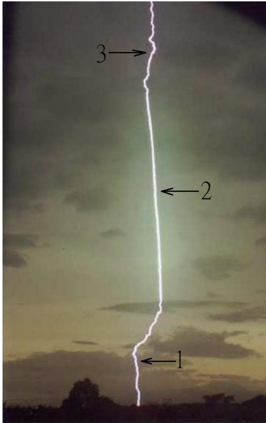
Рисунок 5.2. Интегральная фотография высотной инициированной триггерной молнии (altitude-triggered lightning), полученная в Бразилии 23 ноября 2000 г. (любезно предоставлена др. Осмаром Пинто младшим, INPE). 1 – нижний конец двунаправленного лидера, образованного в результате встречи восходящего положительного лидера и нисходящего отрицательного лидера; 2 – плазма, испаренного медного провода; 3 – восходящий положительный лидер
