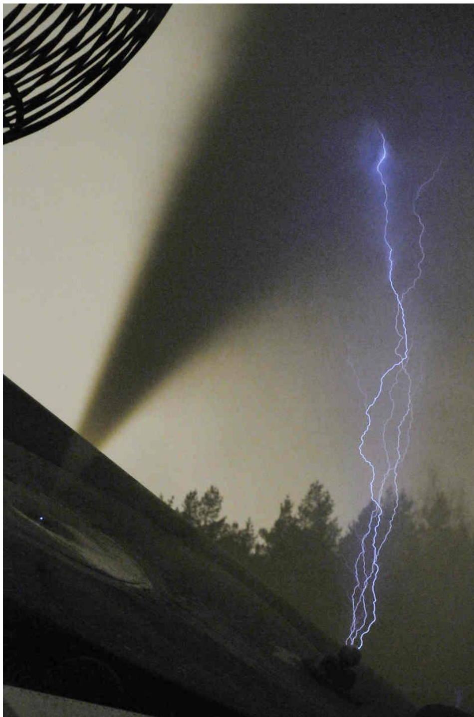
Рисунок 1.2 (адоптировано из [Kostinskiy et al., 2015a]). Снимок, сделанный фотоаппаратом Canon (видимый диапазон; экспозиция — 5 с), отрицательно заряженного облака (наклонная струя, темное образование) и четырех восходящих положительных лидеров длиной около 1,5 м, инициированных заземленной сферой. Внутри облака на фотографии не видны внутриоблачные светящихся образований.
