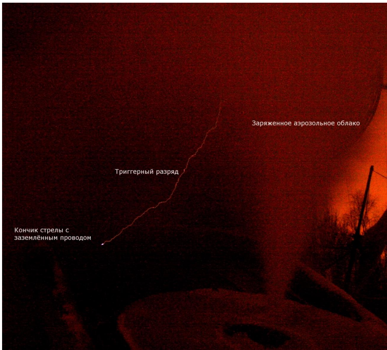
Рисунок 5.15. На интегральной цветной фотографии видна белая точка инициации положительного восходящего лидера с кончика болта (стрелы), летящего слева-направо. Так как эксперименты проводились ночью, то болт и прикрепленный к нему провод не видны. Восходящий положительный лидер имеет длину около 1.5 метра, поднимаясь вверх к отрицательному аэрозольному облаку.
