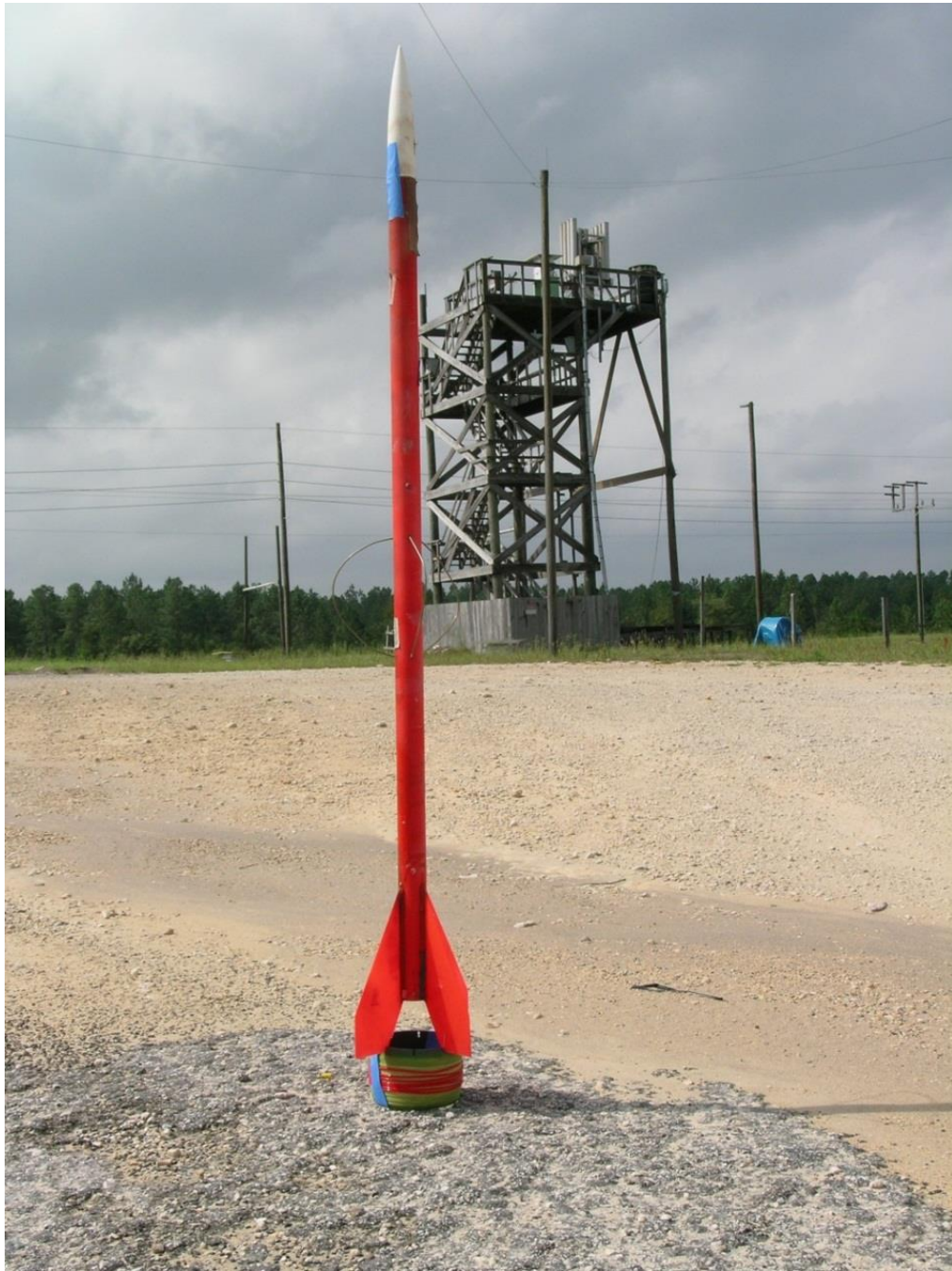
Рисунок 5.4 (любезно предоставлен Владимиром Раковым). Ракета длиной 1 м, несущая провод (намотан на шпульке в хвостовой части) и инициирующая триггерные и высотнo-инициированные триггерные молнии. Фотография любезно представлена Владимиром Раковым.
