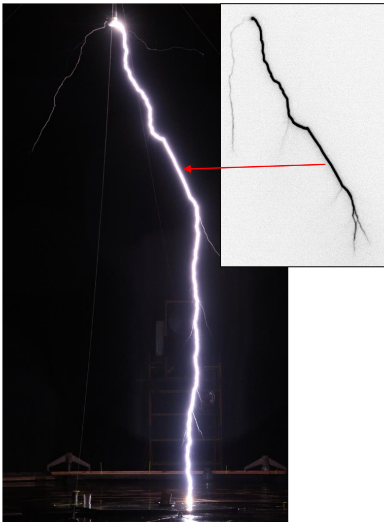
Рисунок 6.18 (событие 2014-09-23_12). Ступень положительного лидера имеет тот же прямолинейный вид на интегральной цветной фотографии (выдержка 4 с, f/8 ), что и на кадре камеры с усилением изображения 4Picos (выдержка кадра 10 мкс, изображение инвертировано). Разрядный промежуток имеет длину 5 м.
