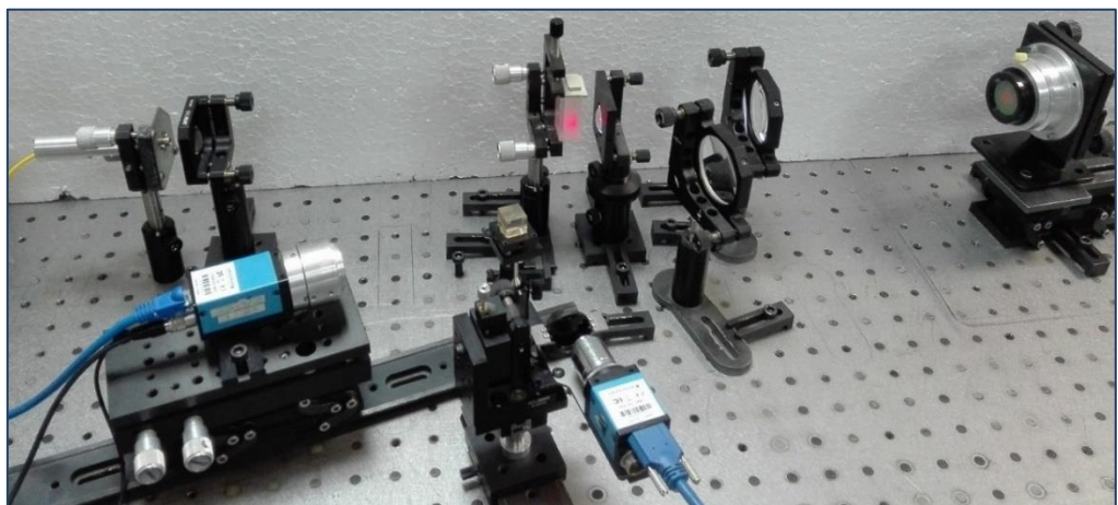
Рис. 64. Схема экспериментальной установки для улучшения фокусировки лазерного пучка, распространяющегося сквозь слой рассеивающей среды.
