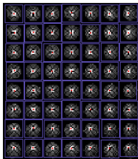
Рис. 30. Пример гартманограммы, полученной в результате моделирования распространения монохроматического коллимированного лазерного пучка сквозь рассеивающую среду, с поисковыми прямоугольниками.
