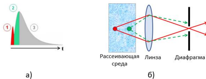
Рис. 2. (а) Баллистическая составляющая импульса излучения, обозначенная цифрой 1, регистрируется первой по времени t , до регистрации рассеянной составляющей, обозначенной цифрами 2 и 3; (б) пространственное стробирование при конфокальной микроскопии — на приёмнике регистрируется только излучение, рассеянное от рассматриваемого слоя среды (показано сплошными линиями), в то время, как излучение, рассеянное от других слоёв среды (показано пунктирными линиями) будет задержано диафрагмой.
