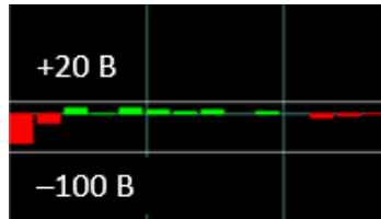
Рис. 70. Рассчитанные начальные напряжения на электродах зеркала (–100...+20 В).
