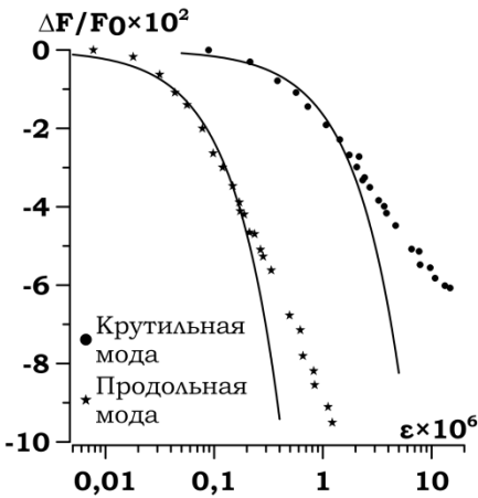
Рис. 5. Зависимость нормированных сдвигов резонансных частот мод кручения и сжатия от амплитуды деформации на резонансной частоте. Сплошные линии отвечают линейным зависимостям \propto \beta\epsilon
