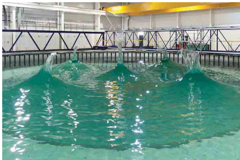
Рис. 1.2.6. Волны, полученные в новом круговом бассейне университета Эдинбурга (результат геометрической фокусировки). (FloWave Ocean Energy Research Facility http://www.flowavett.co.uk/ )
