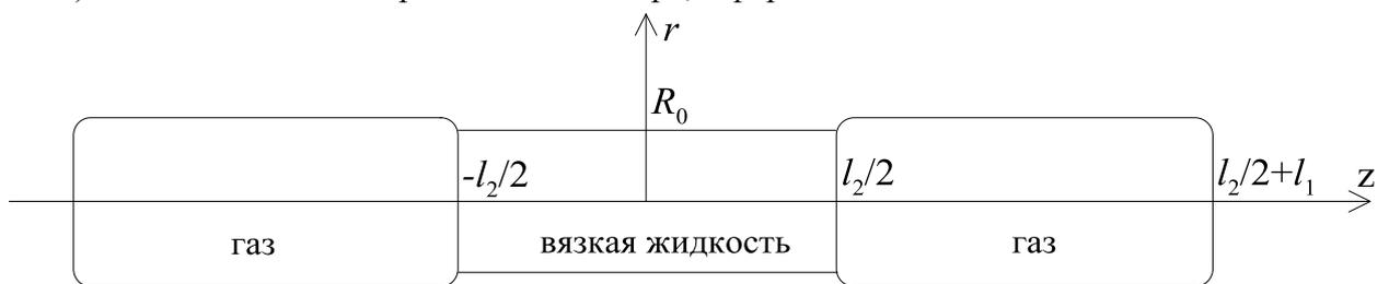
Рис.1.2. Схема капилляра, частично заполненного жидкостью.
